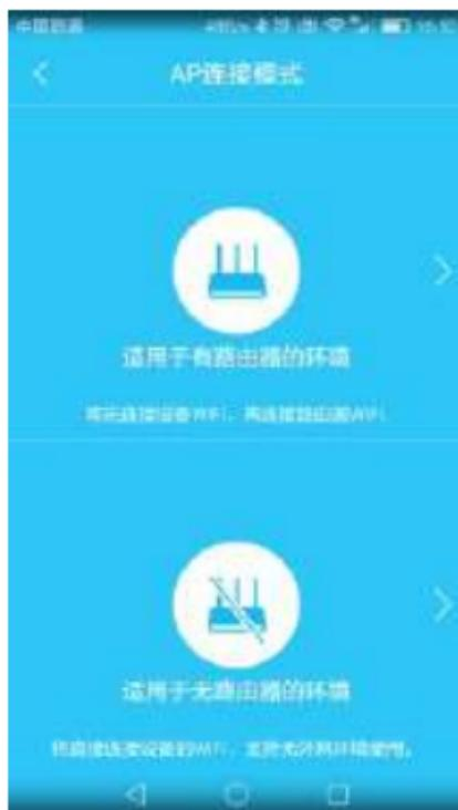
② 点击“切换成功”进入下一步。(摄像机出厂默认为WiFi热点模式，若无法找到摄像机热点，或者已经配置过，可拧开摄像机底部长方形盖子上的四个螺丝，取出盖子，找到reset按键，按住10秒钟复位摄像机，切换到WiFi热点模式)。
