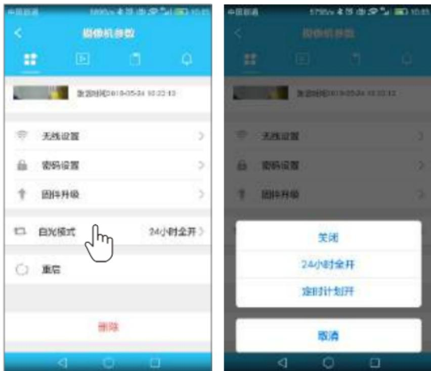
白光灯还有补光录像和强光驱盗的作用。开启移动侦测后，点开摄像机的**“报警”**选项，开启移动侦测报警，找到**“白光”**选项。有关闭，补光和闪烁三个模式可选，点击相应选项选择模式。**注：点选每种模式后，“白光”选项下方会出现相应模式的说明。**
