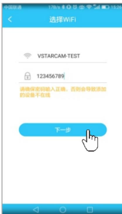
③ APP开始配置无线网络，当听到摄像机提示“无线连接成功”后，等待10 秒左右，APP软件将会出现绑定界面，点击“立即绑定”完成添加操作；
