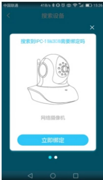
备注：若此过程中摄像机有提示无线连接成功而没有出现绑定界面，请返回到APP 主页，点击右上角的添加图标“+”后，选择“其他添加方式”→“网络摄像机”→“手动添加”方式绑定摄像机即可。
