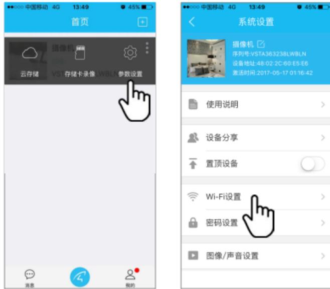
请点击“参数设置”，选择“WiFi设置”，选择你要连接的WiFi，输入WiFi密码，大约60S摄像机重启，完成配置。
