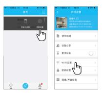
请点击"参数设置",选择"WiFi设置",选择你要连接的WiFi,输入WiFi 密码,大约60S 摄像机重启,完成配置。
