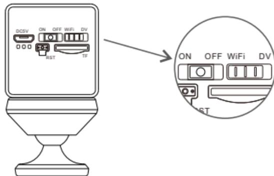
长按电源键开机，并将模式切换键拨到“DV”，插入TF卡可24小时不间断录像。
